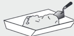
Mezcla preparada para relleno de juntas
